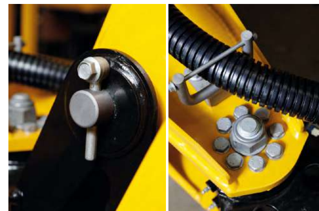
TRATAMIENTO ANTI-OXIDACIÓN de los ejes, de la tornillería y de las piezas pintadas. Resistencia a los test salinos por más de 500h
