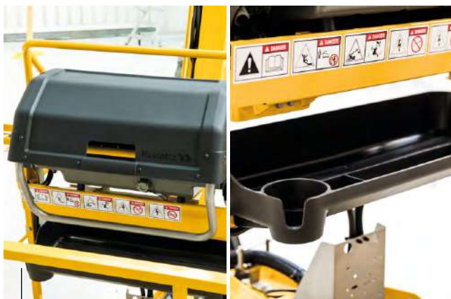
CAPÓT DE PROTECCIÓN Y PORTA HERRAMIENTAS ULTRA RESISTENTES en material compuesto
